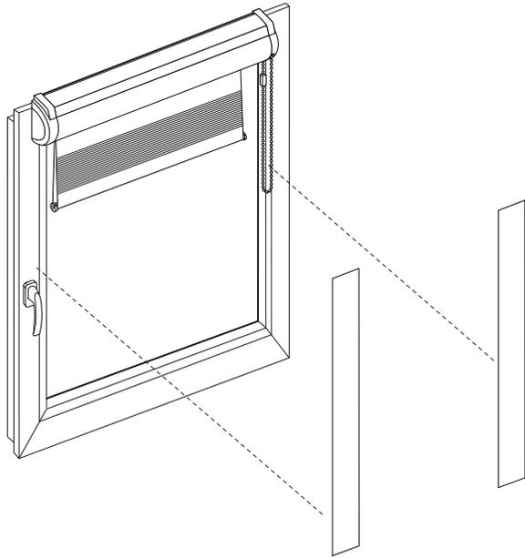
b) Die Seitenschielen auf die Glasleiste kleben. Dabei darauf achten, dass sie oben bündig mit der Rollokassette abschließen. Die Seitenblenden gleichmäßig andrücken.
