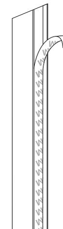
a) Die Schutzfolie auf den Klebeflächen an der Rückseite der Seitenblenden entfernen.
