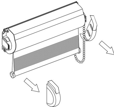
a) Die Abdeckkappen mit leichtem Druck von der Seite nach vorn schieben und entfernen.
