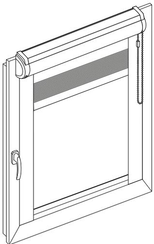
c) Die Seitenblenden verdecken nun die seitlichen Lichtspalte zwischen Doppelrollo und Glasleiste.
