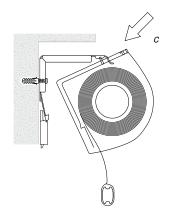
d) Das Kassettenrollo mit einer Kippbewegung an den Winkel drücken und hörbar einrasten lassen.
