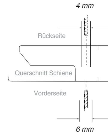
Um die Schienen später an der Wand zu verschrauben, im Bereich zwischen 2 und 17 mm vom Rand der Schiene vorbohren. Rückseite: 4mm, Front 6 mm.
