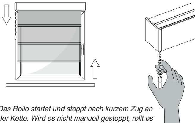
Das Rollo startet und stoppt nach kurzem Zug an der Kette. Wird es nicht manuell gestoppt, rollt es bis zur programmierten Position ab bzw. auf.
