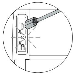
Vor der ersten Verwendung den Motor mithilfe eines Micro-USB Kabels vollständig aufladen.
