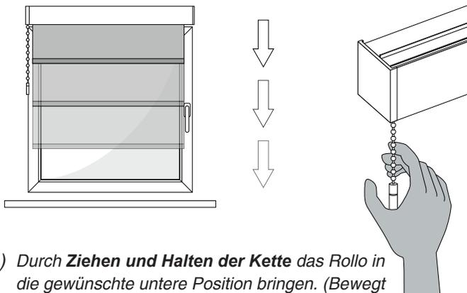
a) Durch **Ziehen und Halten der Kette** das Rollo in die gewünschte untere Position bringen. (Bewegt sich das Rollo nicht in die gewünschte Richtung, Kette kurz loslassen und erneut ziehen und halten.)
