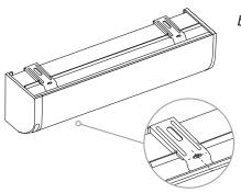
Montageclips an der Kassette befestigen und Abstand zwischen dem vorderen Rand der Kassette und dem vordersten Loch an der Oberseite des Clips ermitteln
