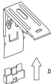
b) Bei der Wandmontage den Sicherheitsclip von unten zwischen Wandwinkel und Wand schieben, bis er hörbar einrastet.
