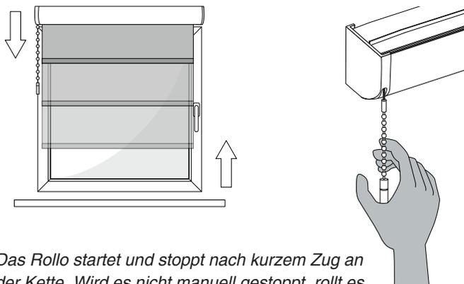
Das Rollo startet und stoppt nach kurzem Zug an der Kette. Wird es nicht manuell gestoppt, rollt es bis zur programmierten Position ab bzw. auf.
