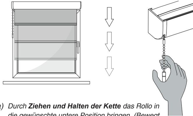
a) Durch **Ziehen und Halten der Kette** das Rollo in die gewünschte untere Position bringen. (Bewegt sich das Rollo nicht in die gewünschte Richtung, Kette kurz loslassen und erneut ziehen und halten.)
