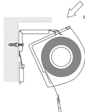
d) Das Kassettenrollo mit einer Kippbewegung an den Winkel drücken und hörbar einrasten lassen.
