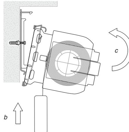
d) Trägerprofil in Montageclips hörbar einrasten lassen.
