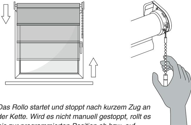
Das Rollo startet und stoppt nach kurzem Zug an der Kette. Wird es nicht manuell gestoppt, rollt es bis zur programmierten Position ab bzw. auf.
