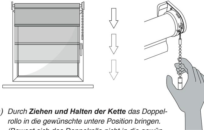
a) Durch **Ziehen und Halten der Kette** das Doppelrollo in die gewünschte untere Position bringen. (Bewegt sich das Doppelrollo nicht in die gewünschte Richtung, Kette kurz loslassen und erneut ziehen und halten.)
