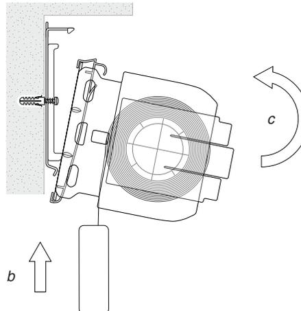
d) Trägerprofil in Montageclips hörbar einrasten lassen.
