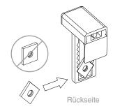
b) Den Montageclip in Position bringen (oben bündig) und Schraube handfest anziehen.
