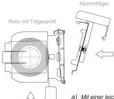
a) Mit einer leichten Kippbewegung den Klemmträger erst in die Nut an der Unterseite des Trägerprofils schieben.
