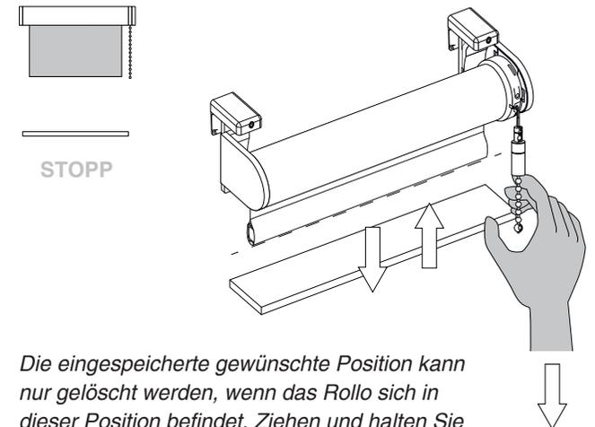
Die eingespeicherte gewünschte Position kann nur gelöscht werden, wenn das Rollo sich in dieser Position befindet. Ziehen und halten Sie die Kette für ca. 7 Sekunden, bis sich das Rollo nach oben und unten bewegt. Gehen Sie zu Schritt 8, um eine neue, andere Position einzuspeichern.
