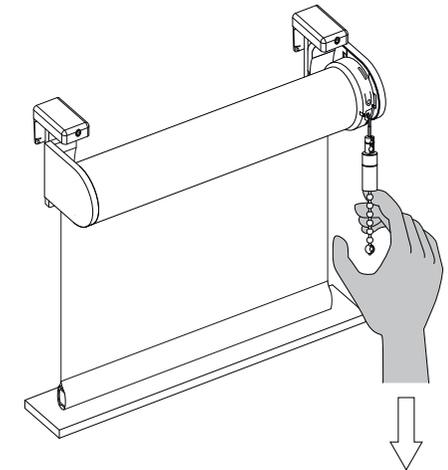
a) Ziehen und halten Sie die Kette, bis das Rollo die gewünschte obere Grenze erreicht hat. Wenn sich das Rollo in die entgegengesetzte Richtung bewegt, lassen Sie die Kette los, dann ziehen und halten Sie sie erneut
