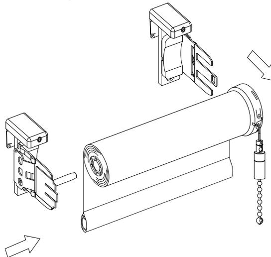
Das Rollo auf die Rolloträger aufschieben. Dabei darauf achten, dass an den Montageprofilen die Aufschrift "metal" zu den Klemmträgern zeigt.
