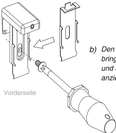
b) Den Montageclip in Position bringen (oben bündig) und Schraube handfest anziehen.
