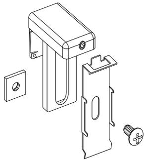
a) Den Montageclip mit Schraube und Mutter am Klemmträger befestigen.
