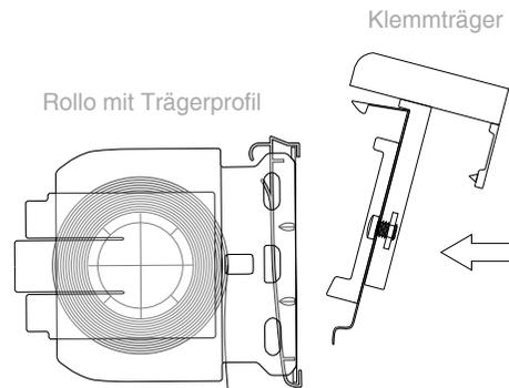
a) Mit einer leichten Kippbewegung den Klemmträger erst in die Nut an der Unterseite des Trägerprofils schieben.
