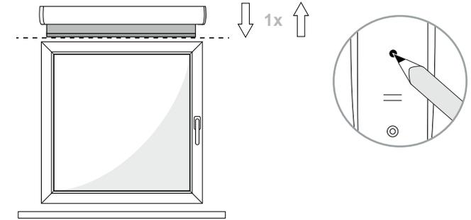
Mussten im Programmiermodus die Richtungstasten dauerhaft gedrückt werden, damit das Rollo sich bewegt, genügt im Bedienmodus ein kurzer Druck auf die  $\uparrow$  oder die  $\downarrow$ -Taste und das Rollo bewegt sich zur entsprechenden Endposition.
