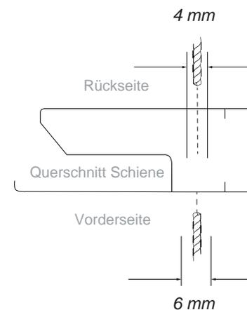
Um die Schienen später an der Wand zu verschrauben, im Bereich zwischen 5 und 14 mm vom Rand der Schiene vorbohren. Rückseite: 4mm, Front 6mm.
