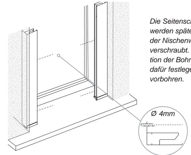
Die Seitenschienen werden später an der Nischenwand verschraubt. Position der Bohrlöcher dafür festlegen und vorbohren.
