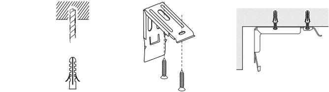
e) Vorbohren, Dübel einsetzen und die Clips an den ermittelten Stellen verschrauben.
