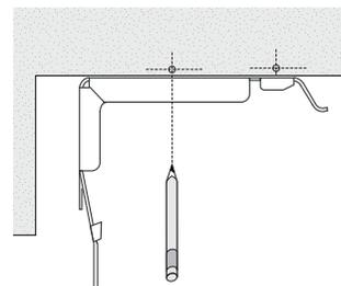
d) Den Clip an der ermittelten Stelle anlegen und zweites Bohrloch markieren.
