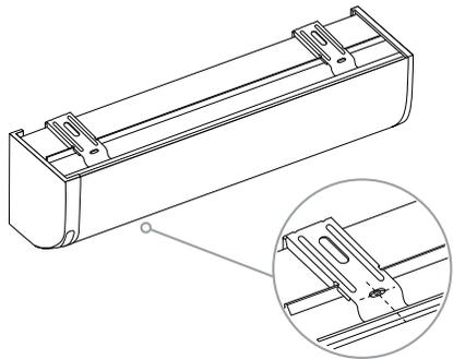
b) Montageclips an der Kassette befestigen und Abstand zwischen dem vorderen Rand der Kassette und dem vordersten Loch an der Oberseite des Clips ermitteln
