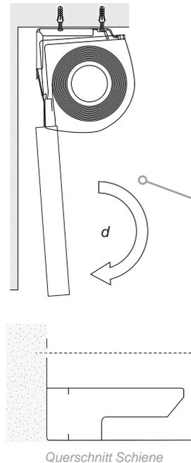
b) Das Kassettenrollo mit einer Kippbewegung an den Montageclip drücken und hörbar einrasten lassen. Die Seitenschienen sitzen nun passend in der Nische.
