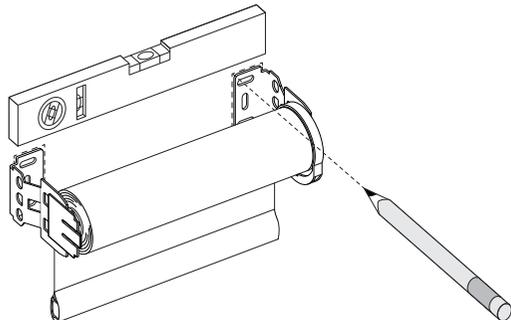
b) Das Rollo an die Gewünschte Position an der Wand halten. Die Position der Rolloträger markieren. Mithilfe der Wasserwaage sicherstellen, dass das Rollo in Waage ist. Die Position der Rolloträger markieren.
