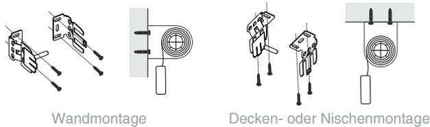
a) Das Rollo zwischen den Rolloträgern Befestigen indem Sie es beidseitig auf die Montageadapter am Rolloträger schieben.
