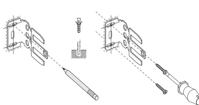
c) Die Rolloträger an die markierten Stellen anlegen und als Schablone zum Anzeichnen der Bohrflöcher Verwenden.
