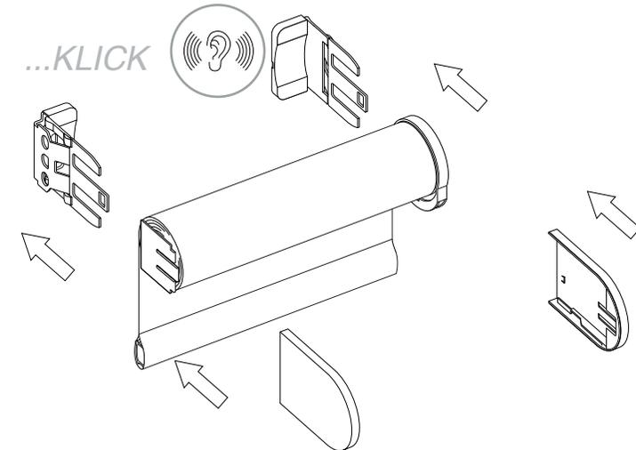
b) Das Rollo mit den Montageadaptern auf die Rolloträger aufstecken, dabei darauf achten, dass die Aufschrift "metal" zur Wand gerichtet ist. Leicht andrücken, bis Das Rollo hörbar einrastet.
