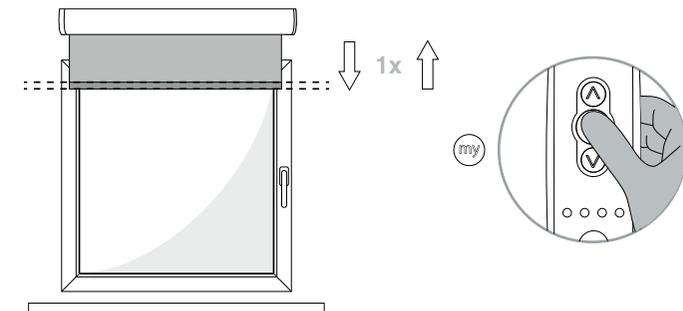
b) Bei Bedarf Laufrichtung ändern
