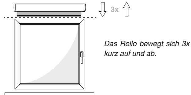
b) Unmittelbar danach die Taste auf der Rückseite der Fernbedienung mit einem Stift oder ähnlichem drücken, um Rollo und Fernbedienung miteinander zu verbinden.
