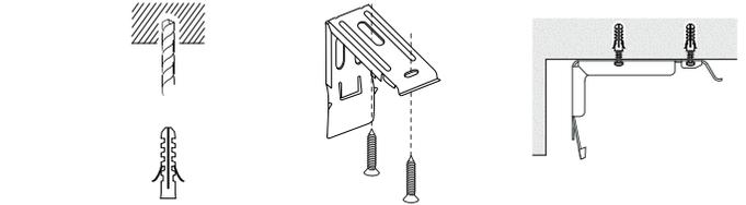
e) Vorbohren, Dübel einsetzen und die Clips an den ermittelten Stellen verschrauben.
