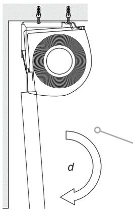
b) Das Kassettenrollo mit einer Kippbewegung an den Montageclip drücken und hörbar einrasten lassen. Die Seitenschienen sitzen nun passend in der Nische.
