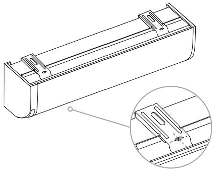
b) Montageclips an der Kassette befestigen und Abstand zwischen dem vorderen Rand der Kassette und dem vordersten Loch an der Oberseite des Clips ermitteln
