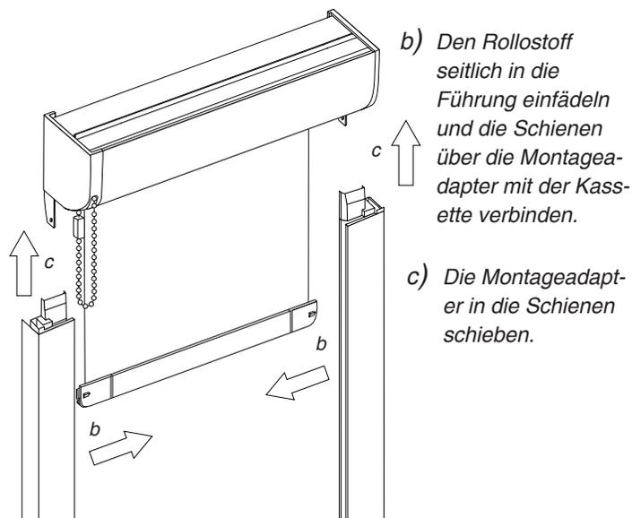
b) Den Rollostoff seitlich in die Führung einfädeln und die Schienen über die Montageadapter mit der Kassette verbinden.
