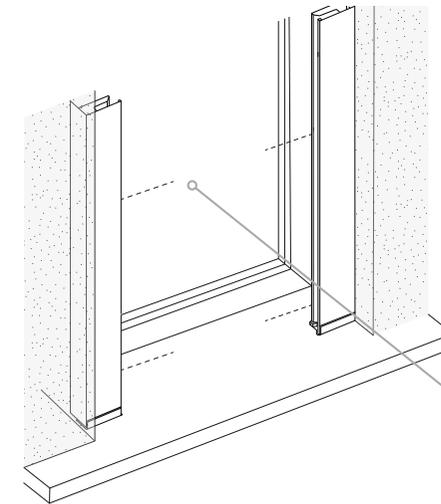
Die Seitenschienen werden später an der Nischenwand verschraubt. Position der Bohrlöcher dafür festlegen und vorbohren.
