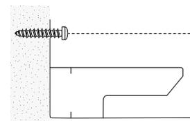
b) Die Seitenschienen an der Nischenwand verschrauben.
