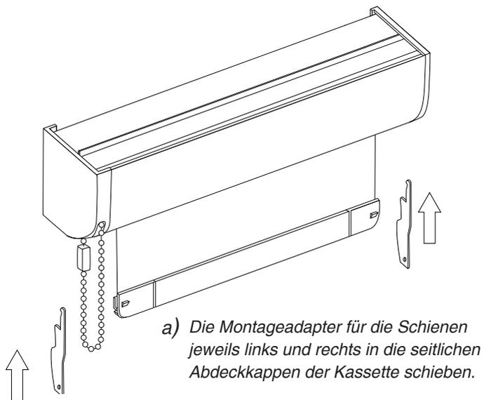
a) Die Montageadapter für die Schienen jeweils links und rechts in die seitlichen Abdeckkappen der Kassette schieben.
