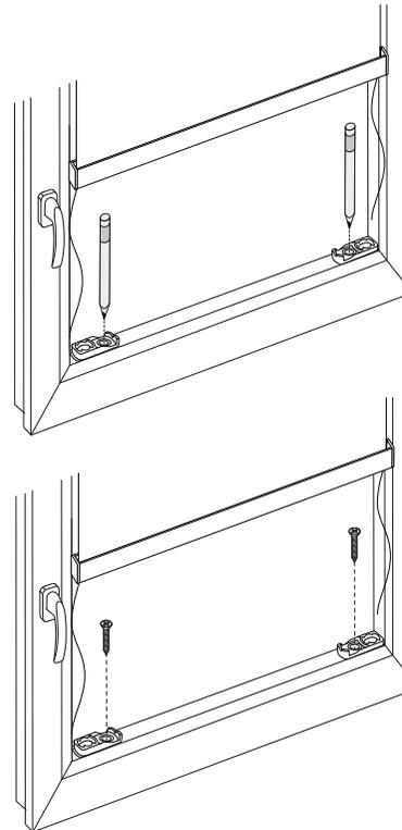
b) Die Unterteile der Spannschuhe so in der Glasleiste positionieren, dass ihr äußerer Rand parallel zum Abschluss des Rollos liegt. Üblicherweise schließen die Spannschuhe bündig mit der Glasleiste. Die Position der Bohrlöcher markieren.
