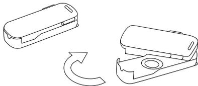
a) Mit einer Vierteldrehung das Ober- und Unterteil des Spannschuhs voneinander trennen.
