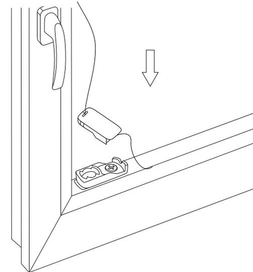
b) Das Spannschuhoberteil wieder auf das Unterteil aufsetzen.
