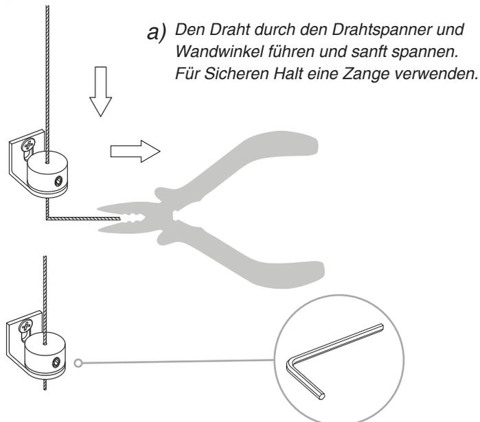
a) Den Draht durch den Drahtspanner und Wandwinkel führen und sanft spannen. Für sicheren Halt eine Zange verwenden.
