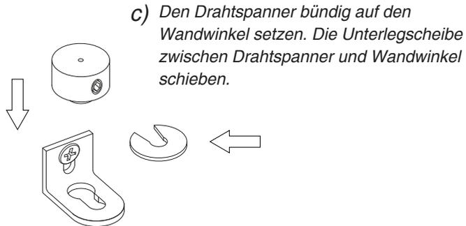
c) Den Drahtspanner bündig auf den Wandwinkel setzen. Die Unterlegscheibe zwischen Drahtspanner und Wandwinkel schieben.
