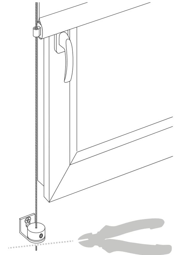
c) Überstehende Drahtreste mit einem Seitenschneider bündig entfernen.
