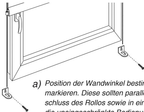
a) Position der Wandwinkel bestimmen und markieren. Diese sollten parallel zum Abschluss des Rollos sowie in einer Höhe, die die uneingeschränkte Bedienung des Rollos erlaubt, liegen.
