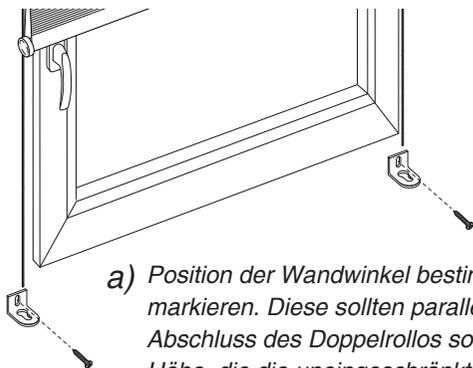
a) Position der Wandwinkel bestimmen und markieren. Diese sollten parallel zum Abschluss des Doppelrollos sowie in einer Höhe, die die uneingeschränkte Bedienung des Doppelrollos erlaubt, liegen.
