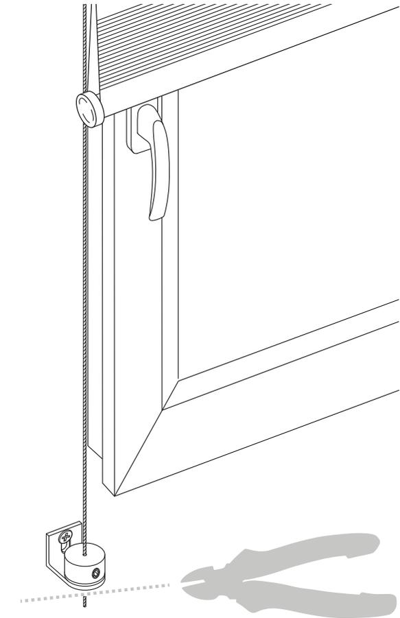
c) Überstehende Drahtreste mit einem Seitenschneider bündig entfernen.
