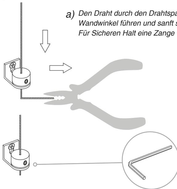
a) Den Draht durch den Drahtspanner und Wandwinkel führen und sanft spannen. Für sicheren Halt eine Zange verwenden.
