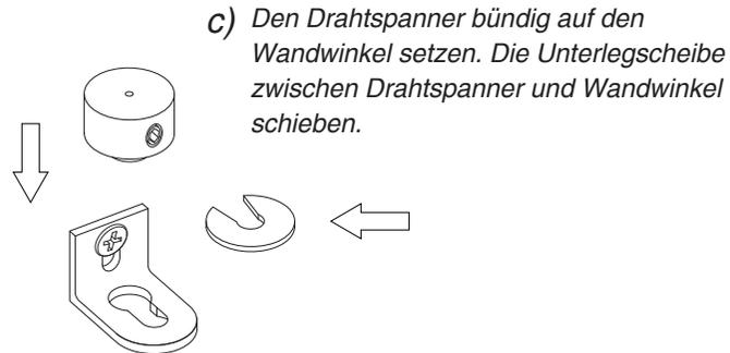
c) Den Drahtspanner bündig auf den Wandwinkel setzen. Die Unterlegscheibe zwischen Drahtspanner und Wandwinkel schieben.
