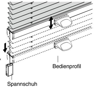
Nach der Funktionskontrolle können die überstehenden Schnüre abgeschnitten werden.
