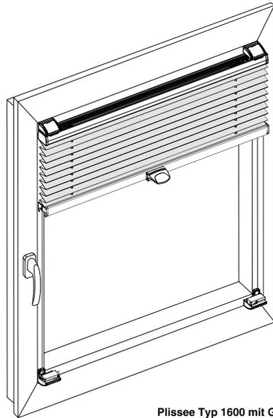
Plissee Typ 1600 mit Glasleistenwinkel
