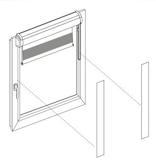
b) Die Seitenschienen auf die Glasleiste kleben. Dabei darauf achten, dass sie oben bündig mit der Rollokassette abschließen. Die Seitenblenden gleichmäßig andrücken.
