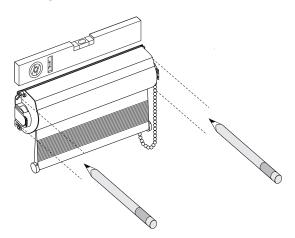
a) Mit einem feinen Bohrer vorbohren und das Doppelrollo mit geeigneten Schrauben befestigen.
