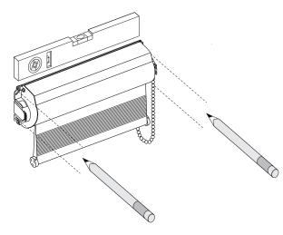
b) Das Doppelrollo in die gewünschte Position am Fenster bringen (ggf. Wasserwaage nutzen) und die Bohrlöcher auf der Glasleiste anzeichnen.
