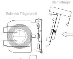
a) Mit einer leichten Kippbewegung den Klemmträger erst in die Nut an der Unterseite des Trägerprofils schieben.
