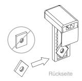
b) Den Montageclip in Position bringen (oben bündig) und Schraube handfest anziehen.
