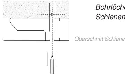
Bohrlöcher zur Montage der Schienen an der Wand markieren.
