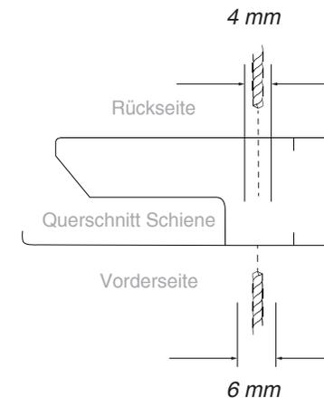
Um die Schienen später an der Wand zu verschrauben, im Bereich zwischen 5 und 14 mm vom Rand der Schiene vorbohren. Rückseite: 4mm, Front 6 mm.
