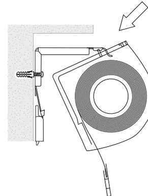
d) Das Kassettenrollo mit einer Kippbewegung an den Montageclip drücken und hörbar einrasten lassen.
