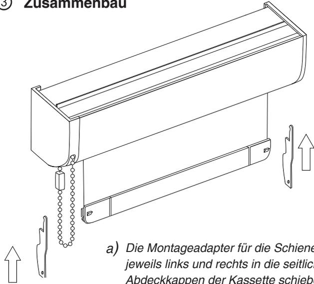
a) Die Montageadapter für die Schienen jeweils links und rechts in die seitlichen Abdeckkappen der Kassette schieben.
