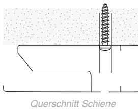
b) Die Schienen so an der Wand verschrauben, dass die Schraube im Inneren der Schiene verschwindet. Dazu Schrauben mit einem Kopf kleiner 6mm nutzen.
