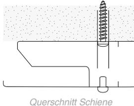
c) Die Abdeckkappen an den Bohrlochern auf der Vorderseite der Schienen anbringen.
