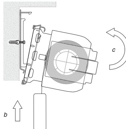
d) Trägerprofil in Montageclips hörbar einrasten lassen.
