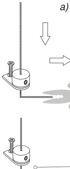
a) Den Draht durch Drahtspanner und Bodenanker führen und sanft spannen. Dabei den Bodenanker so nah wie möglich am Boden halten.
