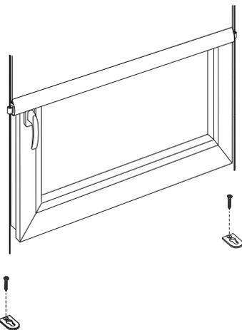
a) Position der Bodenanker bestimmen und markieren. Diese sollten parallel zum Abschluss des Rollos liegen.
