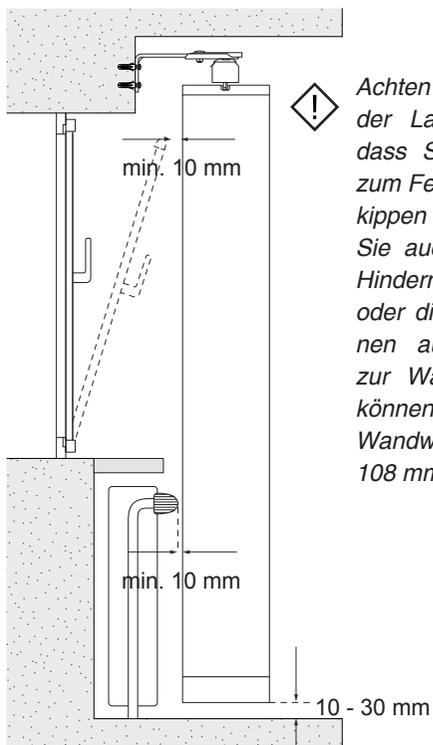
Achten Sie bei der Befestigung der Lamellenschiene darauf, dass Sie genügend Abstand zum Fenster halten, um dieses kippen zu können. Achten Sie auch auf hervorstehende Hindernisse wie Heizkörper oder die Fensterbank. Um einen ausreichenden Abstand zur Wand zu gewährleisten, können Sie die Schenkel der Wandwinkel zwischen 60 und 108 mm tief einstellen.
