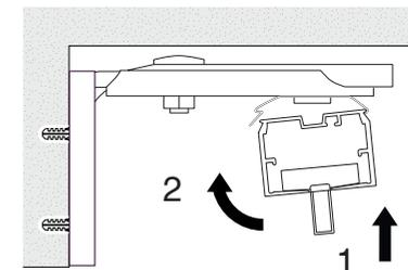
d) Setzen Sie die Schiene mit einer Kippbewegung in den Clip am Wandmontagewinkel ein, sodass diese hörbar einrastet.
