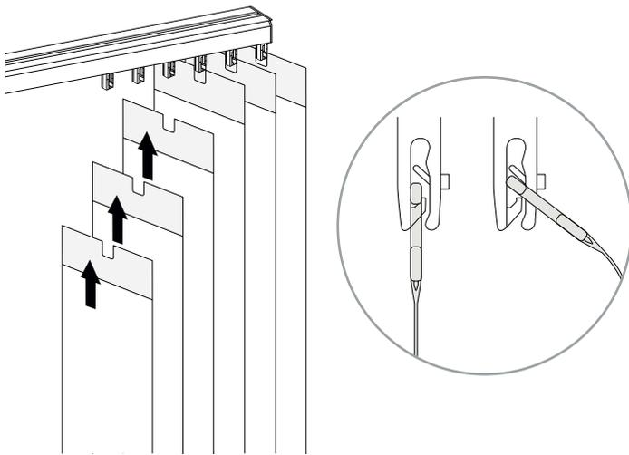
Hängen Sie nun die Lamellen an den Lamellengleitern ein. Achten Sie darauf, dass alle Lamellen gleich ausgerichtet sind (insbesondere bei beschichteten Stoffen). Eine kleine Aussparung im Stoff kennzeichnet das obere Ende der Lamelle. Hängen Sie sie an dieser Stelle mit einer Kippbewegung ein.
