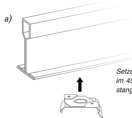
Setzen Sie die Profilklemme im 45°-Winkel auf die Profilstange auf.
