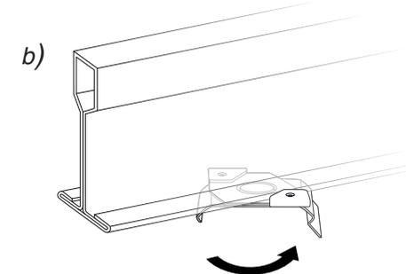
Drehen Sie die Klemme so, dass sie parallel zur Profilstange liegt und sich die beiden Laschen um den Rand des Profils legen. Richten Sie den Halteclip nun so aus, dass die Lippe am Clip zum Fenster zeigt.
