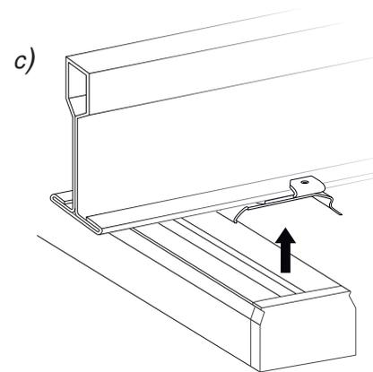
Schieben Sie die Clips so auf den Profilklemmen in Position, dass sie auf einer Linie liegen.
