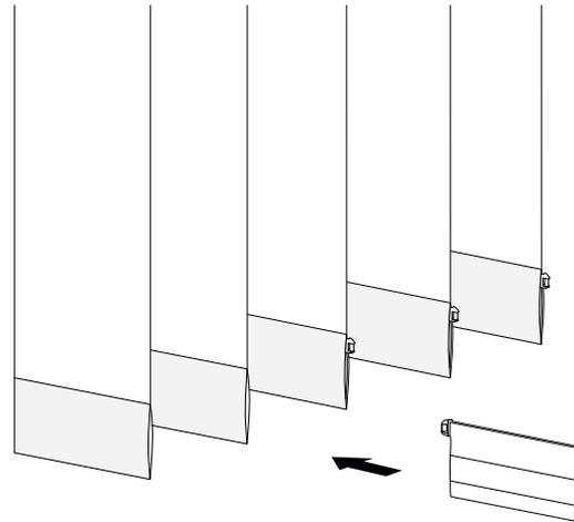
Schieben Sie die Beschwerungsplatten in die Hohlsäume am unteren Ende der Lamellen. Die Halter für die Verbindungskette zeigen dazu nach oben.
