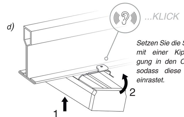
Setzen Sie die Schiene mit einer Kippbewegung in den Clip ein, sodass diese hörbar einrastet.
