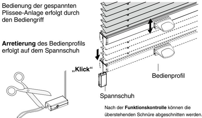
Nach der Funktionskontrolle können die überstehenden Schnüre abgeschnitten werden.
